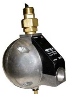
Construido en cuerpo de aluminio, con flotador en acero inoxidable, válvula de descarga manual de latón, y juntas resistentes al aceite, de adaptación particularmente para la purga de condensación de depósitos de aire comprimido.
