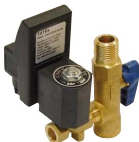
A través de un sensor, controla los intervalos establecidos según la condensación en el interior. Detecta la condensación existente y, en función de la misma, abre la electroválvula de descarga hasta el completo vaciado del líquido. Este sistema reduce casi a cero la pérdida de aire.
