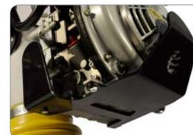
Protección metálica del motor
