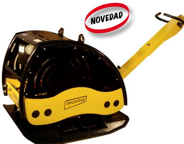
Su diseño robusto y compacto hace de la REVER 700 un equipo fiable que posibilita la máxima profundidad de compactación (hasta 1 metro).
