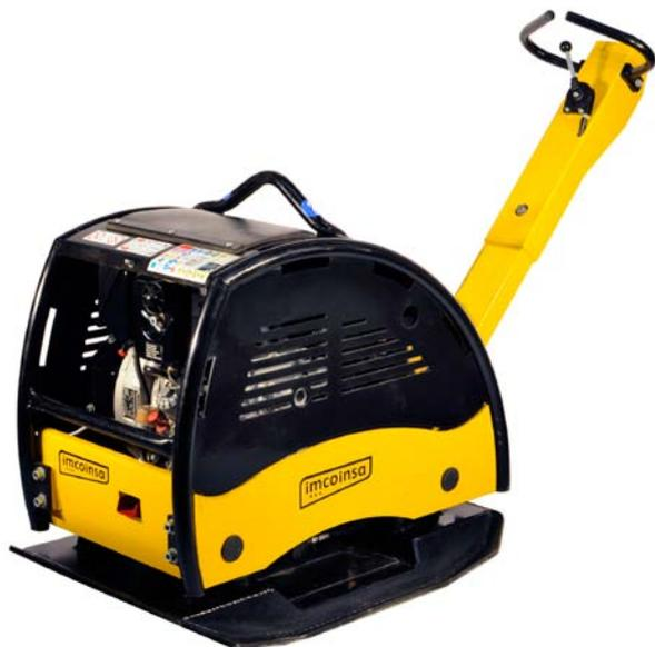
Diseñadas para la compactación de los terrenos más exigentes, su elevada velocidad de desplazamiento y fuerza de compactación aportan un excepcional rendimiento, permitiendo la compactación hasta 70-85 cm de profundidad.
