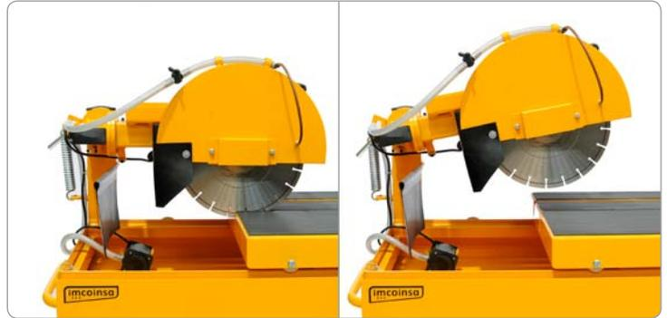
**Regulación de altura del cabezal**
