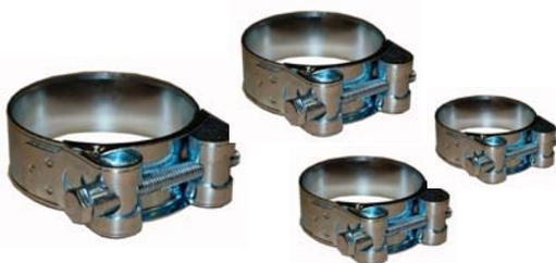
Fabricación conforme a la Norma DIN-3017 con bordes redondeados. Protección antioxidante Cinc Bicromatado color acero blanco. Tres puntos de soldadura. Tornillos Norma ISO 8.8.
