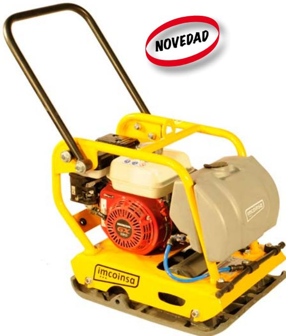
La motorización de este modelo incorpora de serie filtro de aspiración en baño de aceite. Grupo vibrante de novedoso diseño, integrado en la plancha base, aumenta la capacidad de compactación y reduce los elementos sensibles de precisar mantenimiento. El equipo incluye de serie depósito de agua, elemento difusor y juego de ruedas para el transporte.
