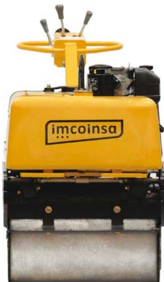
Rodillo vibratorio Dúplex de accionamiento hidrostático. Este sistema suprime los salientes laterales necesarios en los equipos con transmisión por cadena, facilitando así la óptima compactación en los remates perimetrales de muros, bordillos, etc.
