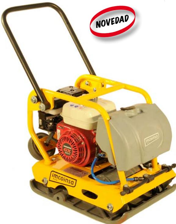
La superior motorización (6,5 HP / HONDA GX 200) aporta a este equipo una excelente potencia de compactación. Dicho motor incorpora de serie filtro de aspiración en baño de aceite, garantizando una larga vida útil con unos bajos costes de mantenimiento. El equipo incluye de serie depósito de agua, elemento difusor y juego de ruedas para el transporte.
